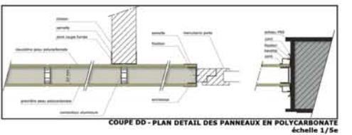
COUPE DD - PLAN DETAIL DES PANNEAUX EN POLYCARBONATE échelle 1/5e
