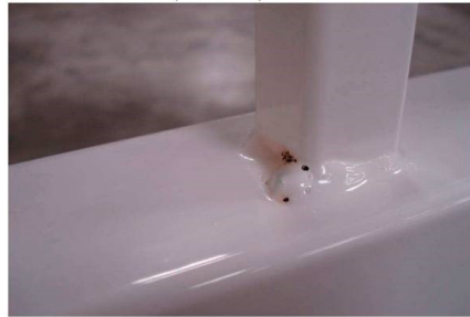
Soudure irrégulière et poreuse Après thermolaquage
