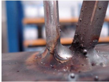
Projections de soudure A réception
