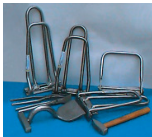
Les toits en acier inoxydable peuvent être assemblés à l'aide des outils habituels sous réserve d'éviter toute contamination par des particules d'acier au carbone.
