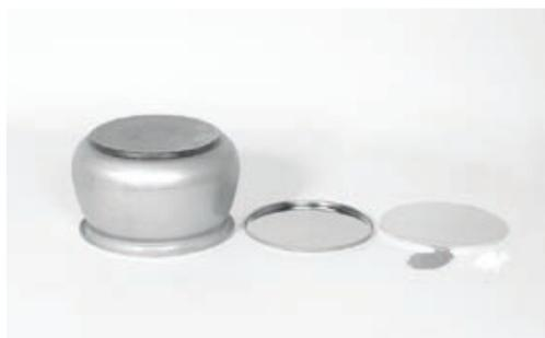
Bien que l'aspect mat du disque initial n'ait rien de l'aspect d'un ustensile de cuisine de haut de gamme, sa rugosité de surface est suffisamment faible pour rendre un bon parachèvement post-fabrication.
