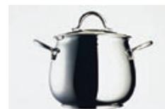
*Les poignées, fabriquées à partir d'une barre ronde ou plate, sont soudées au corps du récipient. En limitant la surface de contact et avec de l'acier inoxydable austénitique (qui dispose d'une conductivité thermique plus faible que d'autres aciers), elles sont optimisées pour une utilisation en toute sécurité et anti-chaleur.*
