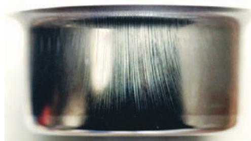
*Cylindre en emboutissage profond en nuance ferritique traditionnelle EN 1.4016 (ci-dessus), montrant l'effet « cordage », et en nuance austénitique EN 1.4301 (ci-dessous). Le cordage est inesthétique et nécessiterait une finition post-fabrication. On peut l'éviter en sélectionnant une nuance ferritique « stabilisée » (comportant du Ti ou du Nb) et par un contrôle stricte des paramètres de laminage et de recuit.*
