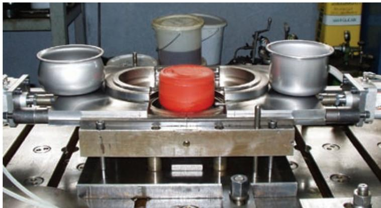
*Le formage de l'acier inoxydable ne se limite pas à des formes cylindriques. On peut apporter un profilé courbe plus complexe (à gauche sur la photo) au cylindre (à droite) à l'aide d'une matrice en métal en deux parties de la forme finale exigée, et d'un emporte-pièce (au centre) constitué d'une série de disques de polymère dur de caractéristiques variables.*
