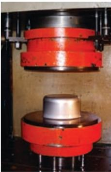
De façon surprenante, la fabrication de cet élégant récipient commence à partir d'un disque plat, d'une épaisseur de 1 mm et d'un diamètre de 400 mm environ. La nuance EN 1.4301 avec une finition laminée à froid 2B ( l'état de livraison du laminoir ) va absorber la déformation considérable appliquée par la ou les presse( s ) concernée( s ). Le diamètre du disque est réduit de moitié lors de ce processus – ce qui constitue à peu près la limite de capacité<sup>5</sup> de formage du matériau.
