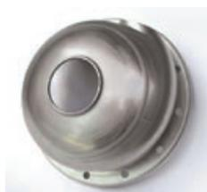
*Corps de pompe à partir d'un flan embouti en acier inoxydable. L'entrée se situe à l'avant et le liquide s'échappe du corps grâce à un orifice hydroformé sur le dessus.*
