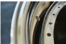
Roue haut de gamme en trois parties : le moyeu en étoile ( en haut ), la jante intérieure ( au milieu ) et la jante extérieure ( en bas ). Cette dernière est en acier inoxydable, qui combine une résistance élevée à un faible poids et une surface lisse.
