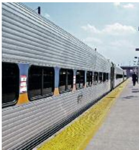
Figure 25 : Des wagons avec des panneaux extérieurs en inox austénitique ont été utilisés dans une large partie du monde, sans problèmes de corrosion galvanique.
