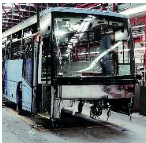
Figure 24 : Utilisé pour les bus et les cars, l'inox (habituellement une nuance ferritique peinte) a prouvé sa compatibilité avec les châssis en acier au carbone.
