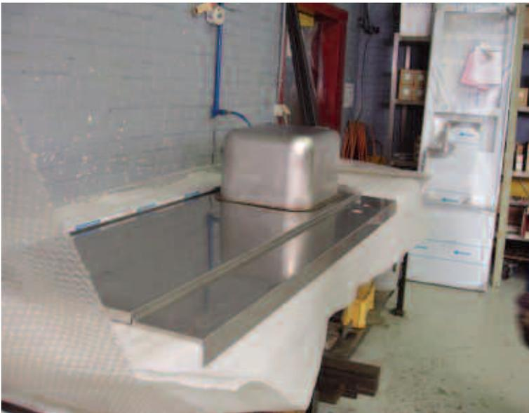
*Si le coût des matières premières en acier inoxydable utilisées pour fabriquer l'objet fini représente une partie notable du coût total, la fabrication et la finition bien réalisées lui ont ajouté une valeur significative. La valeur du produit final doit être protégée en l'emballant soigneusement avant de l'expédier.*
