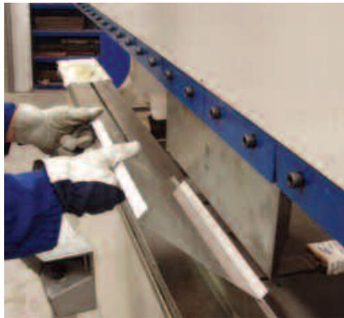
*Il convient d'utiliser si possible des revêtements ou emballages de protection en plastique pour éviter que la surface soit endommagée ou contaminée par le dépôt de fer provenant des outils et de l'équipement de manutention. Le coût de cette protection essentielle doit être incorporé au calcul de prix de la matière première et non considéré comme un « extra ».*
