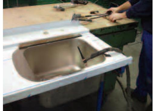
*La cuve et la découpe du plan de travail sont soigneusement ajustées pour minimiser le soudage nécessaire. On consolide cet ajustage par pointage avant le soudage. Une barre de cuivre sert de dissipateur de chaleur pour évacuer aussi vite que possible la chaleur de la zone soudée, afin de minimiser le risque de déformation et le ternissement excessif autour de la soudure ( voir aussi 5.3. ).*
