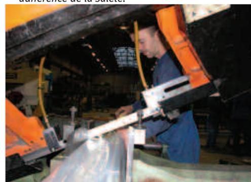
*Les tubes en acier inoxydable peuvent être fournis dans des longueurs standard ou prédécoupés par les distributeurs à la longueur demandée. Ils peuvent aussi être sciés à la longueur voulue dans l'atelier de fabrication. On trouve un assortiment de tubes 2B laminés à froid en usine et diverses finitions polies.*
