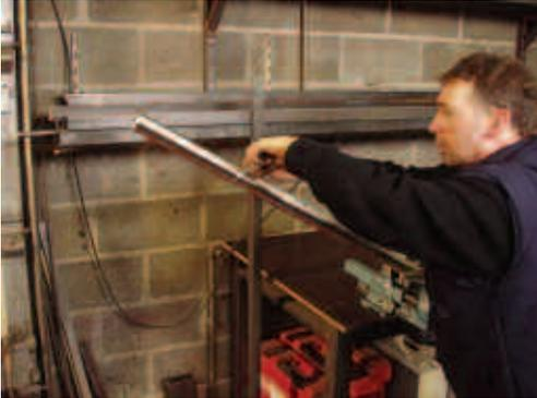
*Lors de l'assemblage des sections de rampes et de balustrades, l'accessibilité pour les dernières opérations de la finition peut être réduite. Ceci rend parfois impossible d'obtenir la finition voulue. La finition ultime des sous-ensembles doit être incorporée au plan de fabrication.*
