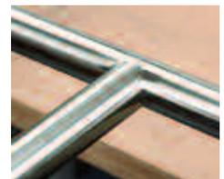
Les raccords en T à l'extrémité des tubes peuvent être préparés avec une grugeuse. Ceci devrait permettre d'effectuer plus facilement de bonnes soudures et de minimiser la finition après soudure nécessaire dans ces types de raccords.
