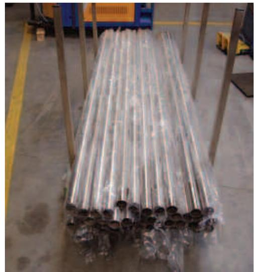
*S'il n'y a pas de raison particulière d'enlever en partie ou totalement le revêtement ou emballage plastique, on peut éviter d'endommager ou de salir les surfaces en le laissant sur les surfaces en acier. Il convient d'utiliser des racks, des chariots et autres appareils de stockage spécialement conçus (comme le chariot en acier inoxydable montré ici pour le stockage de tubes), pour éviter d'endommager et de contaminer les surfaces.*
