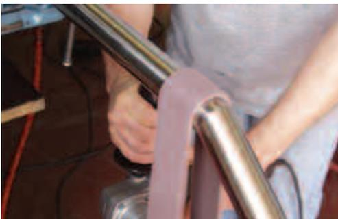
Opération de finition avec un outil électrique facile à utiliser. L'angle aigu du raccord est encore visible, avec la soudure entièrement homogénéisée à la surface.
