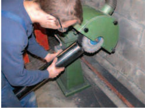
*Après les étapes de meulage initiales, on réalise un polissage mécanique avec un grain de plus en plus fin avant l'avivage final, qui se fait avec une lustreuse fixe à arbre long.*
