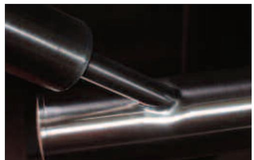
Des entretoises constituées de barres fines raccordant deux tubes sont souvent utilisées pour les rampes et balustrades. Ce type de raccord réduit les efforts de soudage nécessaires et peut aussi offrir un meilleur accès pour la finition qu'un raccord du diamètre des tubes.
