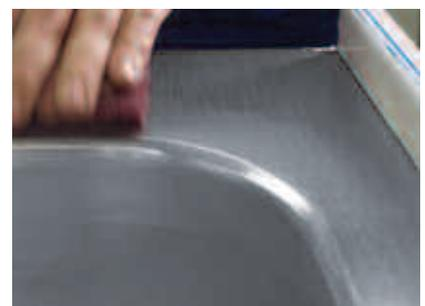
*Après le meulage initial, on utilise une série d'abrasifs à roue à lamelles montés sur une meuleuse droite pour polir le raccord. L'homogénéisation finale du raccord sur la cuve et le plan de travail se fait manuellement à l'aide de tampons Scotch-Brite™.*
