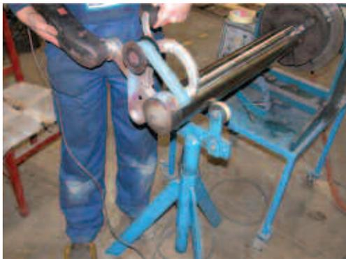
On pré-polit toute la circonférence du tube près de l'endroit où le couvercle a été soudé à son emplacement. L'outil de polissage du tube utilisé permet de traiter une grande section radiale du tube à partir de n'importe quelle position, d'où une finition polie plus régulièrement.
