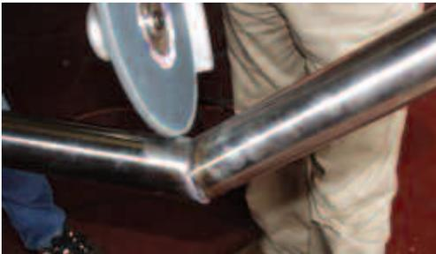
Traitement de l'angle intérieur avec un outil de finition des angles internes.
