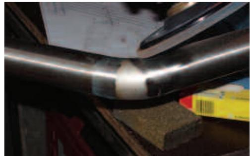
*Tout le pourtour du raccord peut être prétraité avec uniquement des abrasifs à disque à lamelles.*
