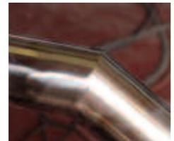
Les raccords de tubes en angle biseauté exigent un travail de découpe et d'ébavurage précis pour assurer un ajustement net avant soudage et réduire le risque de blessures par coupure. Après avoir enlevé les bavures de sciage des bords externes à l'aide d'une meuleuse fixe à bande, on peut effectuer de bonnes soudures plus facilement et minimiser les retouches après le soudage.
