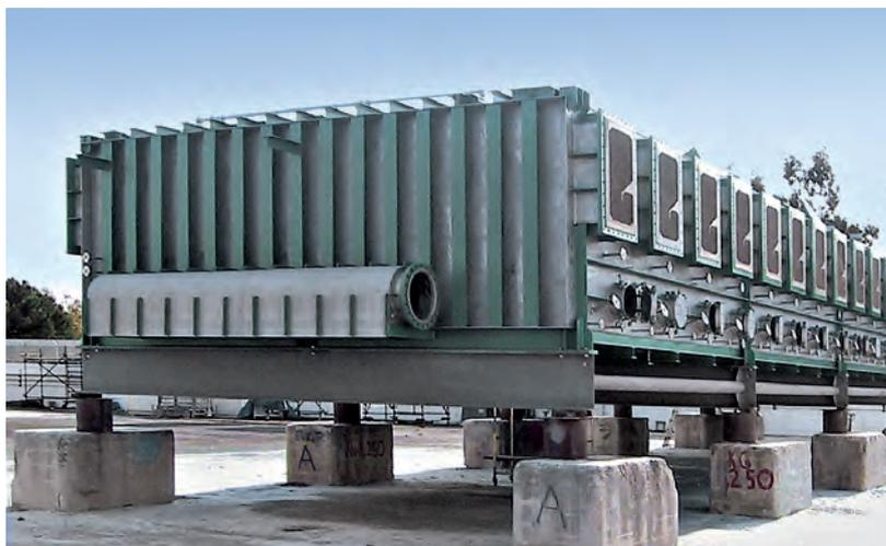
Elément d'une installation de dessalement d'eau de mer par distillation à détentés étagées (MSF), aciers duplex EN 1.4162 (UNS S32101) et EN 1.4462 (2205) (Source : Outokumpu)
